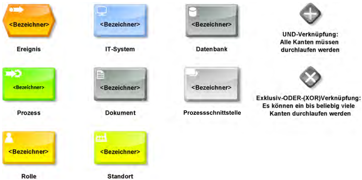
Abbildung 3.1: Konkrete Syntax (Notationselemente) erweiterter Ereignisgesteuerter Prozessketten in der im Modellierungswerkzeug ARIS Express verwendeten Fassung
